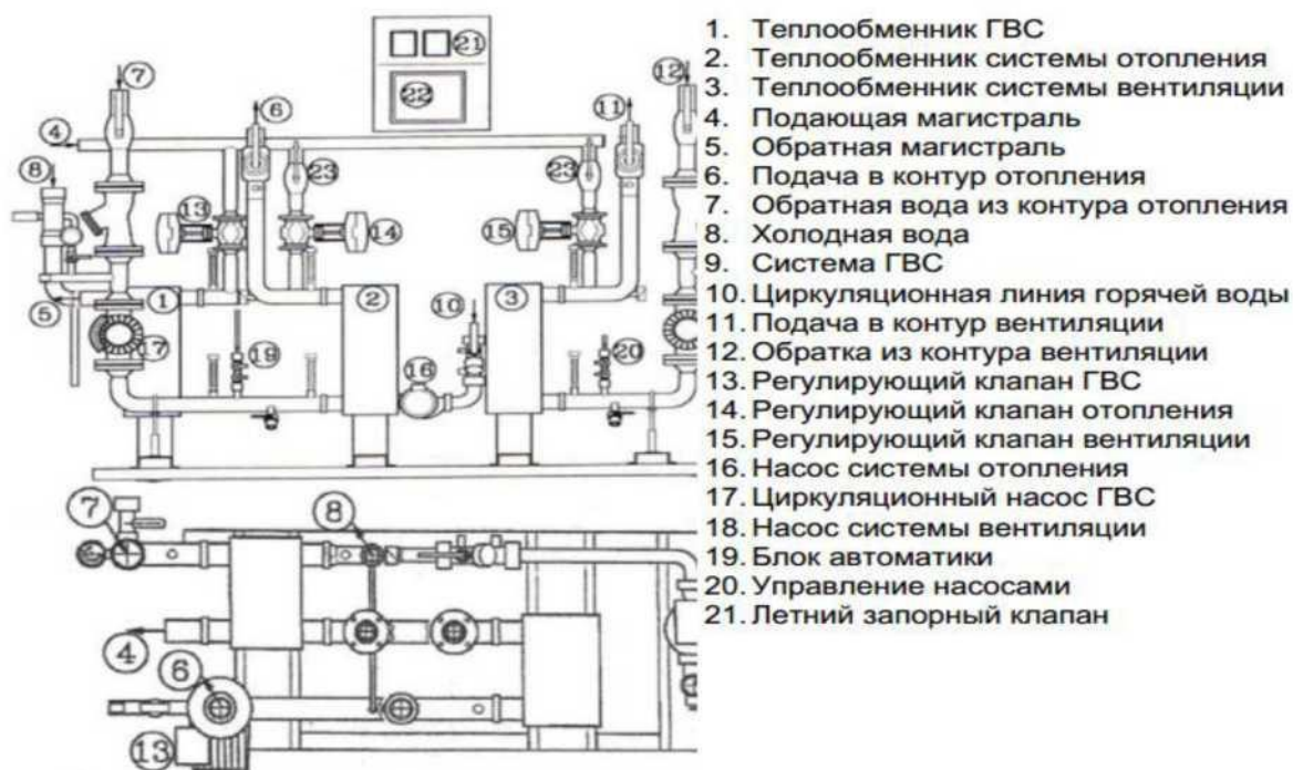
Рисунок 1 - Принципиальная схема индивидуального автоматизированного теплового пункта.
