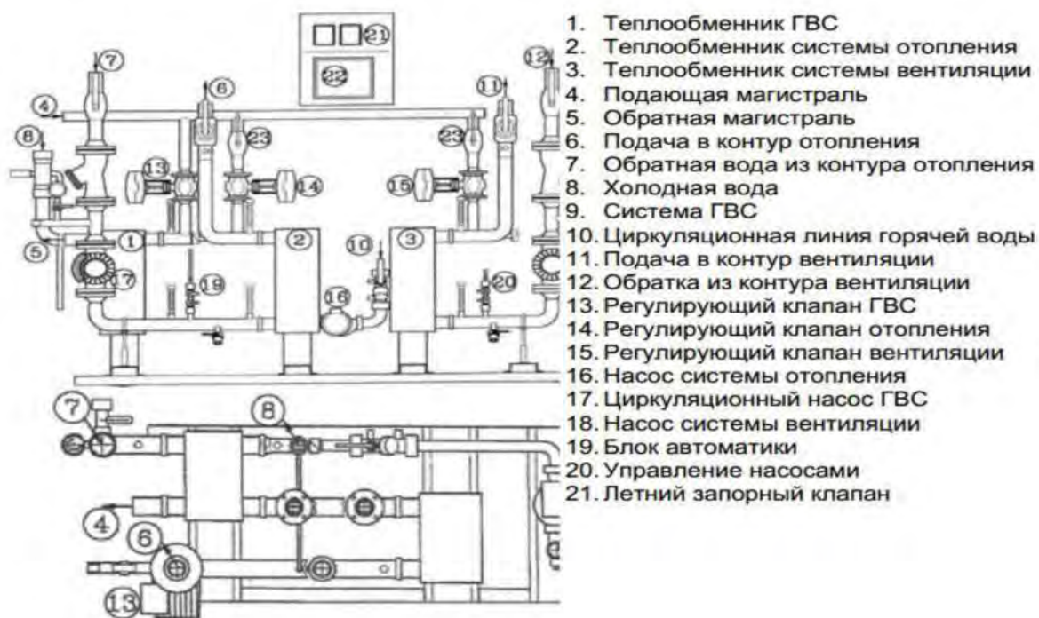
Рисунок 1 - Принципиальная схема индивидуального автоматизированного теплового пункта.
